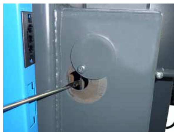
Проверкаиочисткарегулированияпервичного вторичного воздуха через коэффициент очистки крышкой
