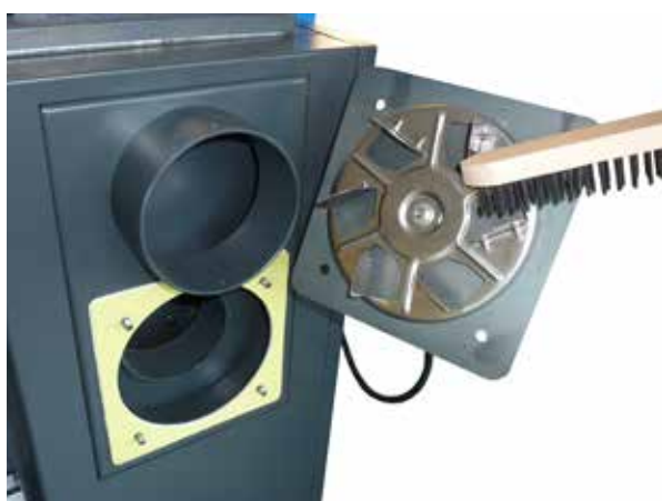
Пример очистки рабочего колеса и проверки правоте лопастной вентилятор на извлечение
