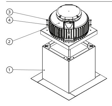
■ Dachventilator (2) mit Schrauben und Scheiben (3) und (4) auf Dachsockel (1) befestigen
