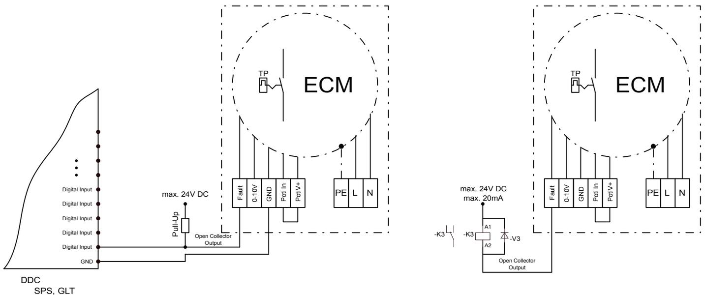
Ein Open-Collector Ausgang ist ein digitaler Kleinspannungsausgang, bei dem über ein Pull-Up-Widerstand die Höhe der Spannung für das High Signal vorgegeben wird.
