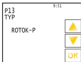
Regelungstyp auswählen, dann durch Berühren der Schaltfläche „▲“ (4s halten) kann die Regelungsart geändert werden.
