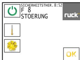
**Störung Sicherheitsthermostat - Temperaturüberwachung Heizregister**
