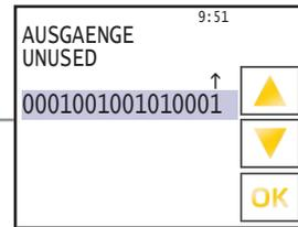
Die einzelne Ausgänge können mit der Schaltfläche „▲“ und „▼“ abgefragt werden. Die Auswahl erfolgt von rechts nach links.
