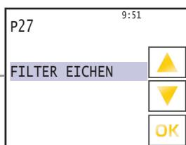
Mit Drücken der Schaltfläche „▲“ fährt das Gerät automatisch in den Eich-Modus. Anzeige blinkt „FILTER EICHEN“. Nach erfolgter Eichung erscheint die Anzeige „FERTIG“. Nach dem Kalibriermodus wird die Anzeige des Verschmutzungsgrades wieder 0% gesetzt. Der Filterwechselzähler wird dabei um eins erhöht.
