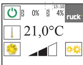
Beim Anlegen einer Spannung am Gerät, wird die Batterie auf ihre Funktionsfähigkeit geprüft. Eine leere Batterie der Zeitschaltuhr wird Ihnen in der Betriebsanzeige mit einem Batterie-Symbol angezeigt.
