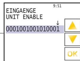
Die einzelne Eingänge können mit der Schaltfläche „▲“ und „▼“ abgefragt werden. Die Auswahl erfolgt von rechts nach links.
