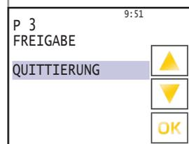
Das Gerät kann nur eingeschaltet werden, wenn der Kontakt geschlossen ist. Ist der Kontakt offen, so erscheint auf den Display „FREIGABE FEHLT“. Der Kontakt muss geschlossen und anschließend mit der Schaltfläche „OK“ die Freigabe quittiert werden. Als werkseitige Betriebsart ist AUTOMATISCH eingestellt!
