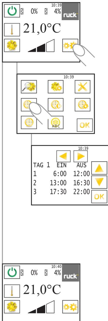
Im Display blinkt in Zeile (1), die Anzeige für den Zeitpunkt, zu dem das Gerät am Tag 1 (Montag) angeschaltet werden soll (EIN). Mit den Schaltflächen „▲“ und „▼“ können Sie die Stunden einstellen und anschließend durch die Schaltfläche „▶“ die Eingabe bestätigen. Die Anzeige springt weiter auf die Minuten, die Sie ebenso mit den Schaltflächen „▲“ und „▼“ einstellen und mit Schaltfläche „▶“ bestätigen können.
