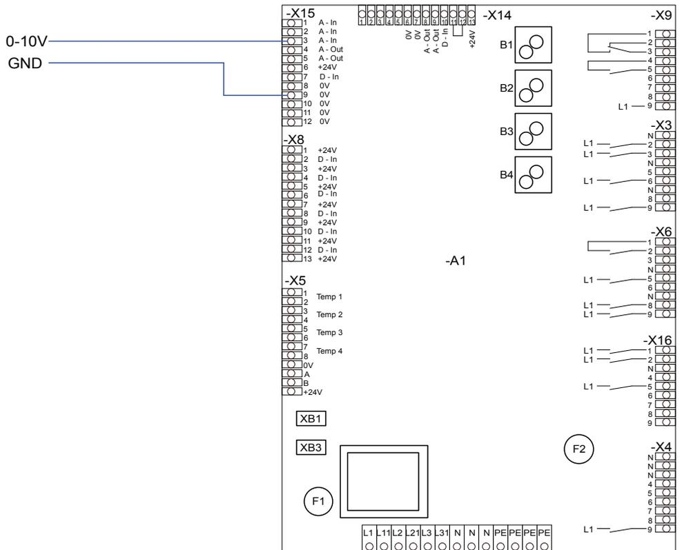
**ROTO K ... V**    Anschlußplan für Parameter P13
