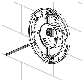
Подведите кабель питания к вентиляционному отверстию, просверлите отверстия для крепежа и установите дюбели.
