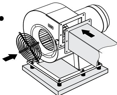
**Последовательность монтажа вентилятора ВЦУ(ц)**
