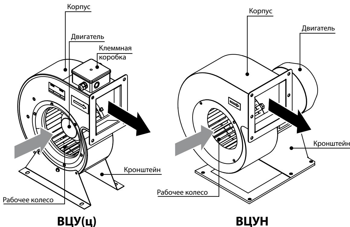
Вентилятор серии **ВЧУ(ц)** состоит из металлического корпуса, к которому через фланец прикреплен электродвигатель и впускное кольцо. На приводном валу закреплено рабочее колесо. Снизу к электромотору прикреплен кронштейн для монтажа вентилятора. Вентиляторы **ВЧУН** изготавливаются в правосторонней и левосторонней модификации. В первом случае рабочее колесо вращается по часовой стрелке, а во втором – против часовой стрелки, вид со стороны притока воздуха.
