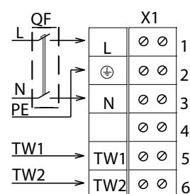
**3. магнитным пускателем и термоконтактом**
